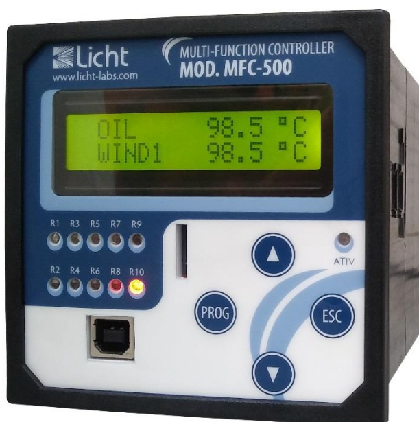
Figura 1.1. Controlador MFC-500/T (versão 96x96)
